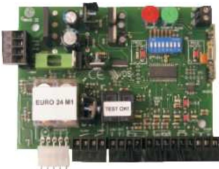
Apparecchiatura di comando 1 Motore 24Vdc
